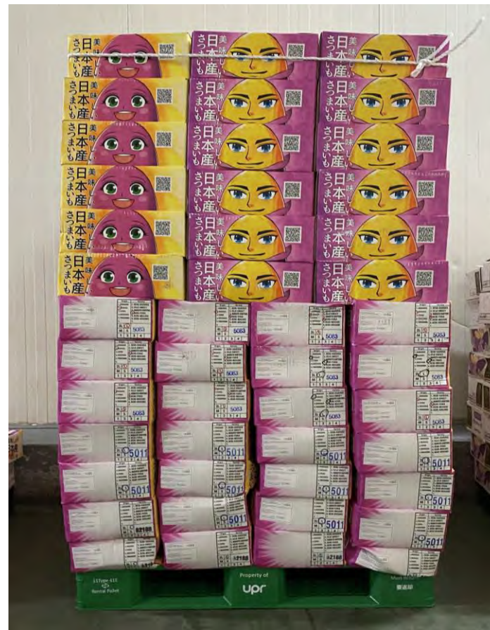
荷重に耐えきれず潰れている
