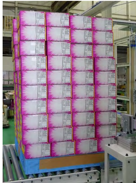
固縛機で固縛を失敗した粗い積み方
