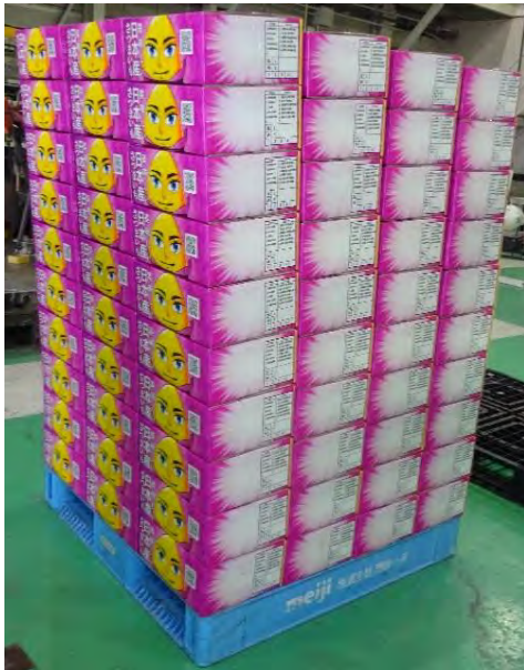
固縛機で固縛できた整った積み方
